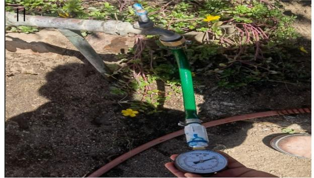
La medición de presión en tomó domiciliaria se realizó mediante un manómetro y en esta prueba obtuvimos una lectura de 0.75 Bar.
