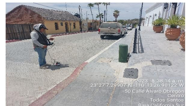
Se muestra inspección en red de distribución utilizando geófono mediante micrófono pata de elefante. Con la medición obtenida del computador y con lo observado se determinó que no existe fuga.
