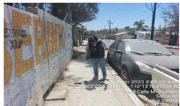
Se muestra detección de fuga. A la izquierda carátula del equipo donde indica el sitio mediante la frecuencia acústica y a la derecha panorama.
