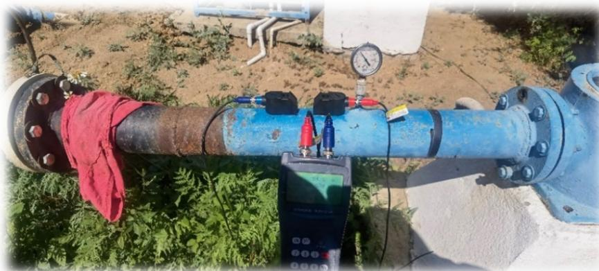
Se muestra la colocación de los transductores y vista de la carátula del equipo utilizado.
